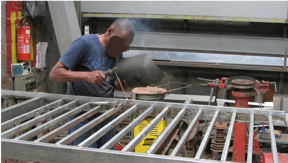
Figura 9 - Operação de ponteio e coluna de fumos de solda em zona respiratória
